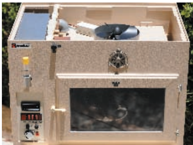
Incubadora mostrando el ventilador
